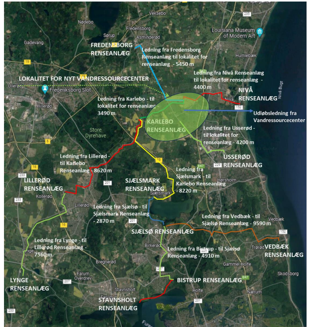
Figur 4-1 Principiel skitse for afskærende transportledninger mod fælles vandressourcecenter Øresund. Tracé for transportledning fra Usserød Renseanlæg er ændret på dette kort efter høringen (se kapitel 7). Endelig placering af transportledninger fastlægges i en senere fase i projektet. Delstrækninger af afskærende ledninger mellem pumpestationer ved de eksisterende renselanlæg er markeret med forskellige farver, som i forslag til Plan for ny Rensestruktur anvendes til opgørelse af ledningslængder og -dimensioner.
