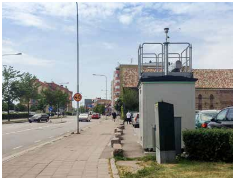
Här pågår mätningar av kvävedioxid, partiklar ( PM_{10} ) och svaveldioxid i Trelleborgs kommun. Särskilda regler finns om vilken mätutrustning som ska användas och hur den ska placeras i gaturummet.
