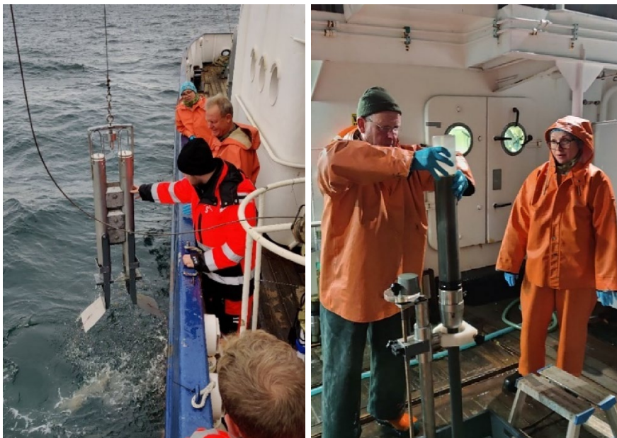
Figur 9. Provtagning av mikroplast i utsjösediment i Skageraks djuphåla, med Gemini-corer, samt sektionering av kärnorna.
