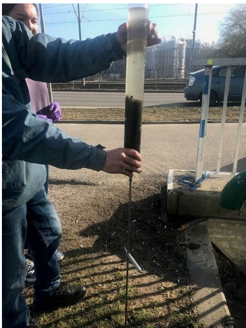
Figur 26. Sedimentprovtagning av det urbana vattendraget Kvillebäcken, Göteborg, med Kayak-sampler (Hydrobios). Översta 2 cm samplades upp från 10 replikat till ett samplingsprov för vidare provupparbetning.
