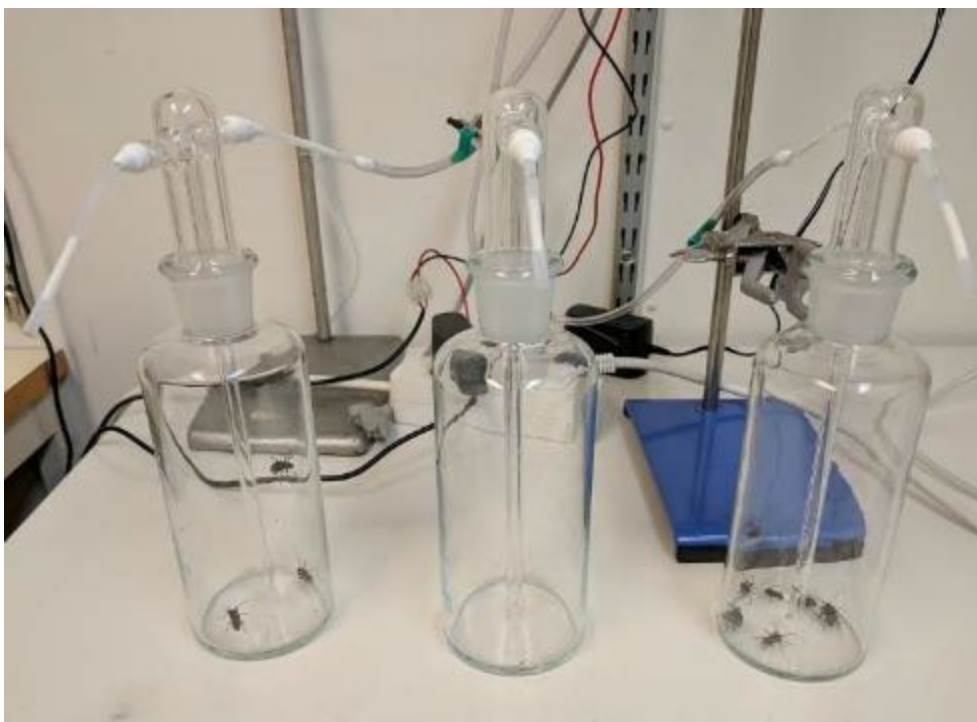
Figur 2. Uppsamling av doftämnen från insamlade vedskalbaggar, placerade i glasflaskor. Med hjälp av en luftpump sugs luft från flaskan genom ett filter som absorberar substanser från luften i flaskan. Ett likadant filter placerat i flaskans luftinsug renar den ingående luften från omgivningens doftämnen. Genom att göra parallella uppsamlingar från hanar, honor och en tom kontrollflaska kan man avgöra vilka kemiska substanser som avges av insekterna, samt vilket av könen som sänder ut eventuella doftsignaler. Foto: Björn Eriksson.
