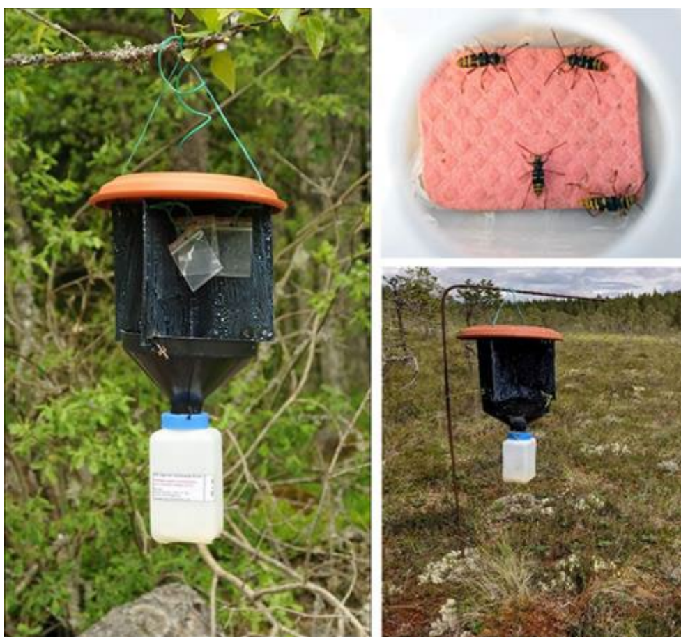
Figur 5. Metod för fällfångst av insekter. Feromonbeten utgörs av plastpåsar placerade vid fällans plastskivor där insekterna slår emot och trillar ned i en uppsamlingsbehållare.
