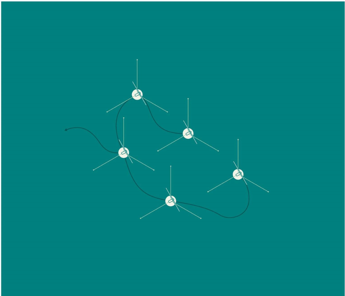
Figur 12. Bild ovanifrån som visar hur vindkraftverken med tillhörande förankringslinor är sammankopplade via interna elkablar. Illustratör: Tobias Green.
