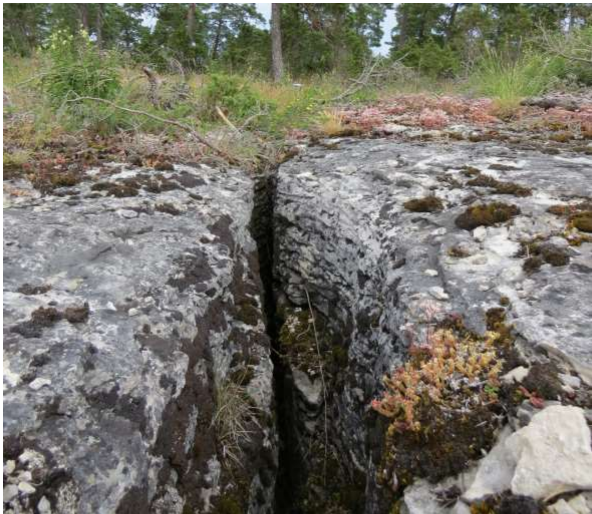
Figur 15. Ett område i östra delen av den sökta täkten (vit streckad linje). Revkalkstenen är här kraftigt karstifierad med sprickorientering åt både NV-SO, NO-SV och O-V. De sprickor som är riktade NO-SV och O-V är de grövsta vi funnit i området (upp till 35 cm breda). I fotot (röda ringen i flygfotot) syns en av dessa breda sprickor. © Krister Mild. Flygfoton: © Lantmäteriet.
