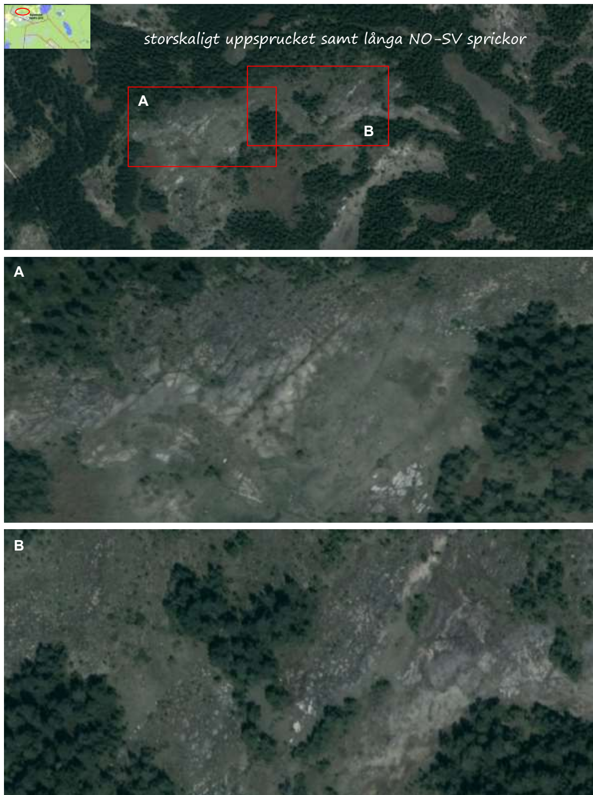
Figur 12. Ännu ett storskaligt uppsprucket område i nordvästra delen av undersökningsområdet. I bild "B" och övre delen av "A" syns oregelbundet uppspruckna (delvis frostsprängda) kalkhällar. Dessa underlagras av en kalkstenshäll som också är mångformigt uppsprucken, men där långa och djupa sprickor i NO-SV orientering dominerar. Flygfoton: © Lantmäteriet
