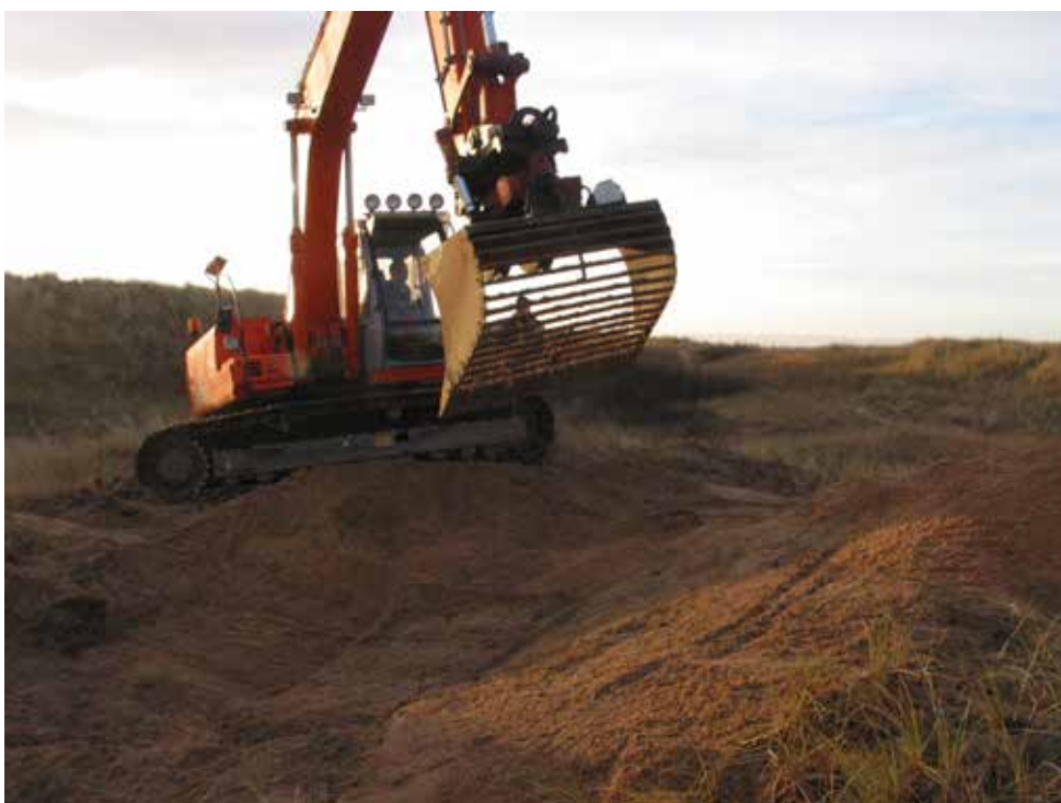
Figur 16. Med gallerskopa kan vresrosens djupa rotsystem sållas bort, och öppna sandblottor skapas. Foto: Krister Larsson.
