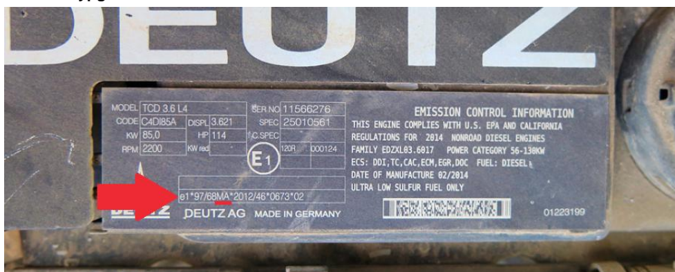
Figur 1. Bilden visar hur en skylt där bl.a. motorns typgodkännandenummer framgår. Pilen visar var typgodkännandenumret finns.
