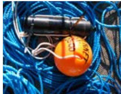
Figur 1. En hydrofonboja VR1 med flytkula och ankringslina. Tabellen ger dataloggerens specifikationer.
