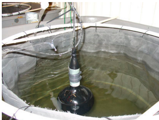
Figur 1. Sändarhydrofon nedsänkt i mitten av tråget. Bilden visar också den nätkasse som användes i delstudie 2.
