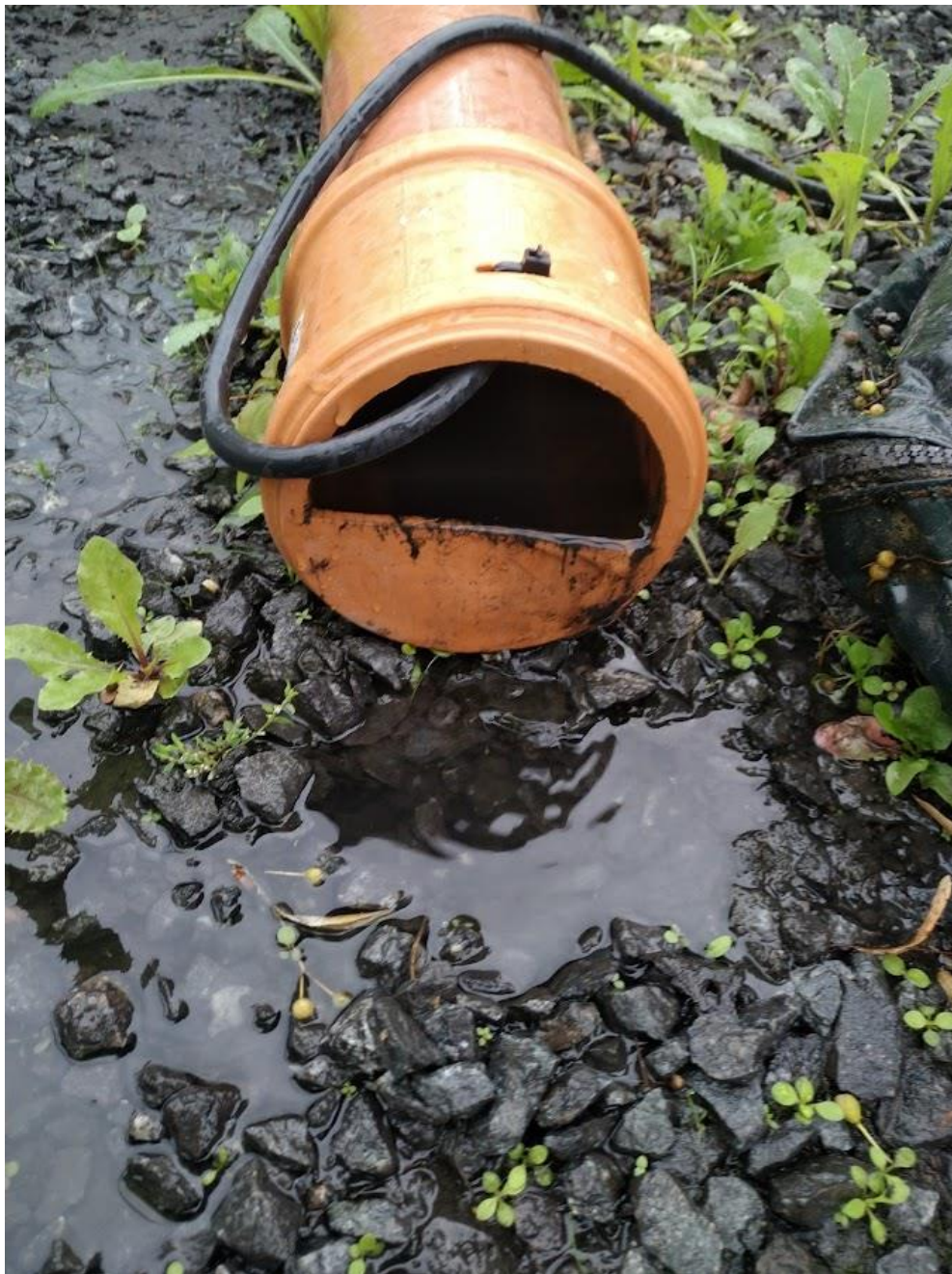
Figur 15 Mätning flöde, inlopp R1. Givare och mikro-skibord.
