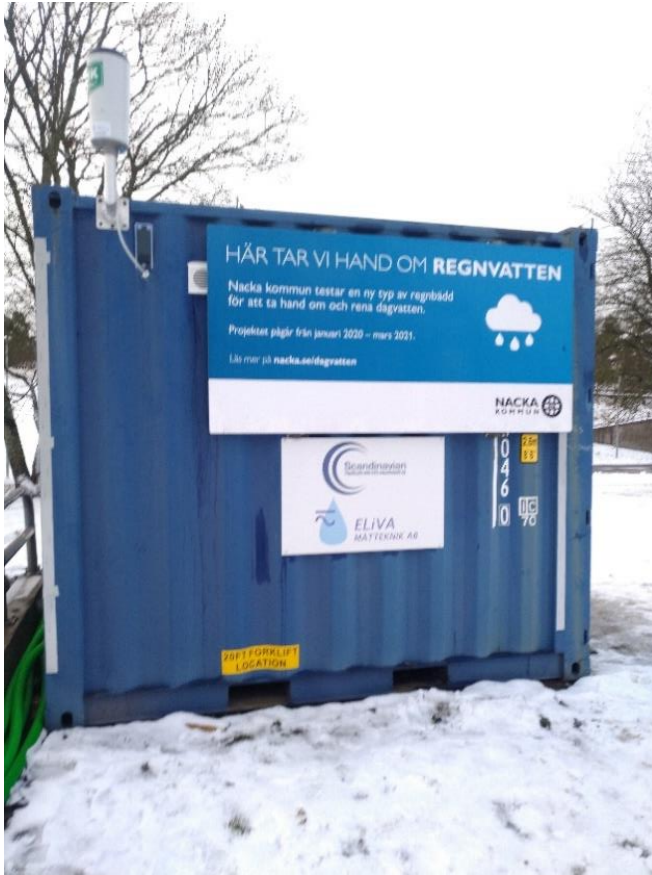
Figur 10 Provtagningscontainer med nederbörds­mätare på taket.
