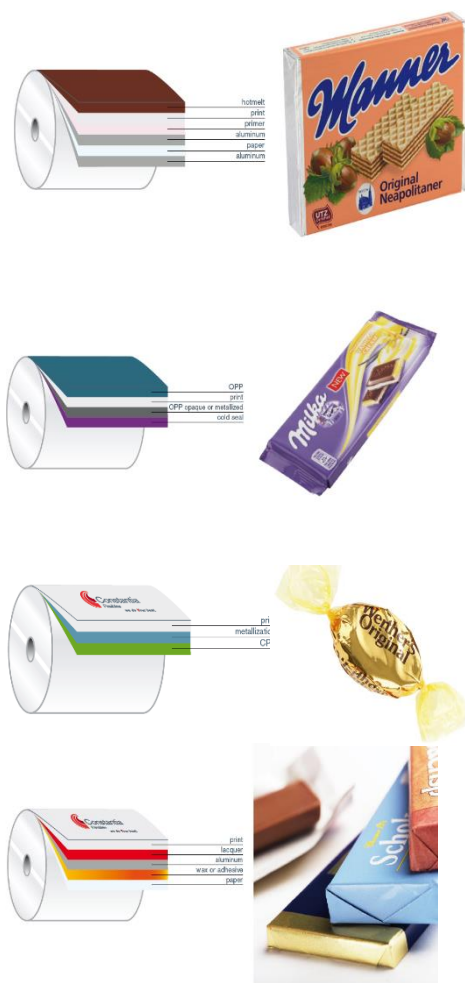
Figur 24. Exempel på materialsammansättningar i godispapper. Bilder: Constantia Flexibles.
