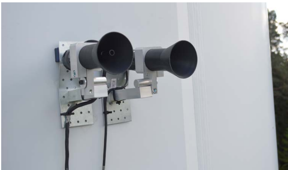
Figur 3. Placering av mikrofoner strax ovanför dörren till vindkraftverket. Mikrofonerna är riktade 90° ut från vindkraftverket. Den ena mikrofonen är ansluten till Avisoft, den andra till D500X.
