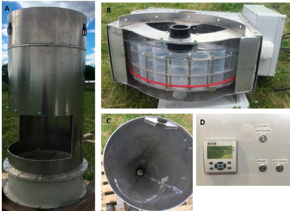
Figur 6. Den färdiga insektsfällan. (A) Genom öppningen där revolvermagasinet ska sitta kan man skymta fläkten. (B) Revolvermagasinet med 21 burkar. Den vita lådan till höger innehåller datorer för styrningen av fällan. (C) Nättratten sedd ovanifrån. Insekterna sugts ned i nättratten och hamnar i den aktiva burken längst ned. (D) Kontrollpanelen där tiden för när fällan är aktiv kan ställas in.
