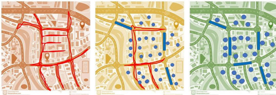
Figur 5-2 Schematisk skiss över beräkningsalternativen för kombinerat system med referensalternativ, mindre strikt respektive mer strikt krav. De röda strecken står för ledningar, de blå cirkelarna för LOD på fastighetsmark och de blå rektanglarna för LOD i gatumark.
