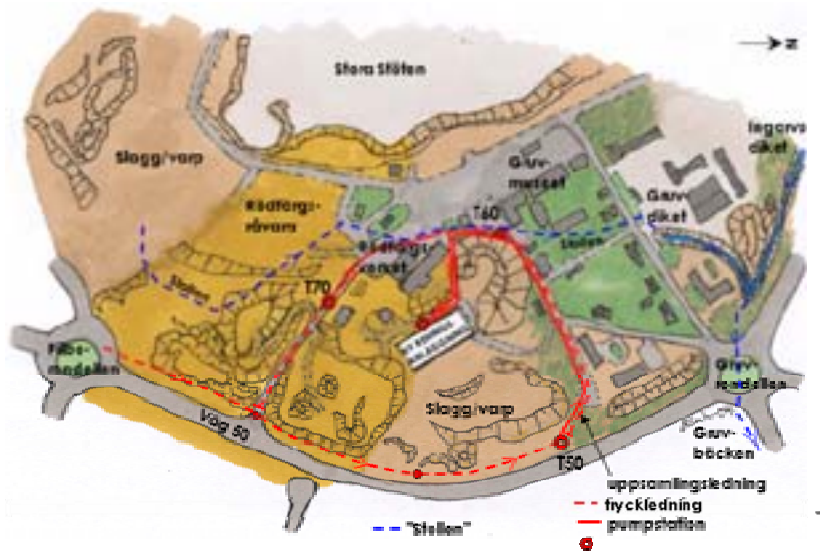
Figur 7. Uppsamlingsystem för lakvatten (förorenat grundvatten) från gruvområdet.
