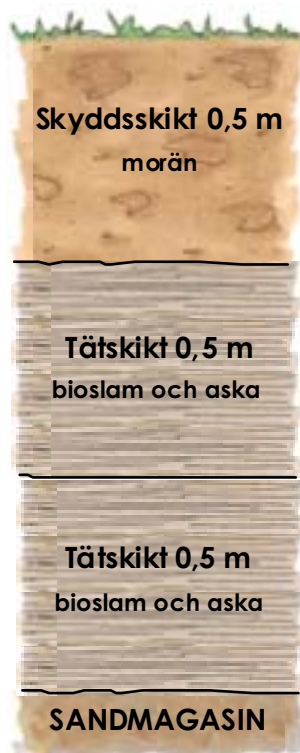
Figur 5. Sluttäckningens utformning på Ingarvsmagasinet i Falun.
