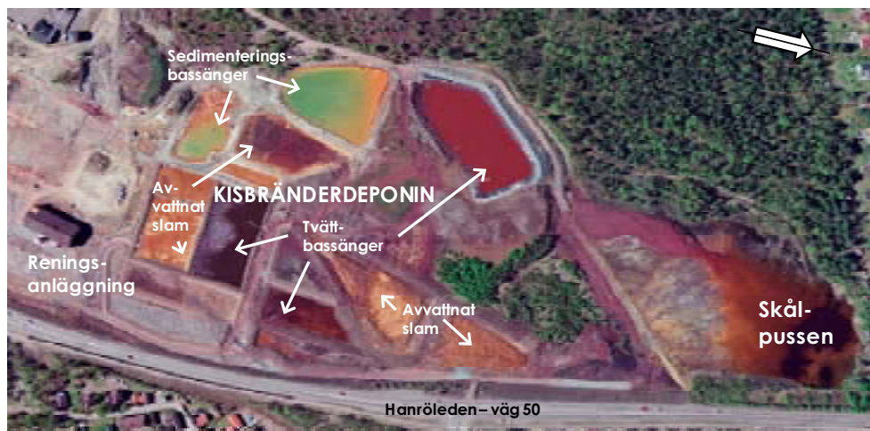
Figur 2. Flygfoto av kisbränderdeponin i Falun under pågående efterbehandling genom in situ tvättning, 1997. © Lantmäteriet Gävle 2010. Medgivande 75986229
