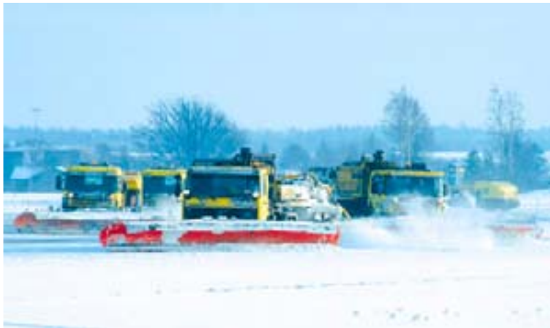
Figur 15: Snöröjning av banan. Källa: LFV, Foto: Tommy Säfström
