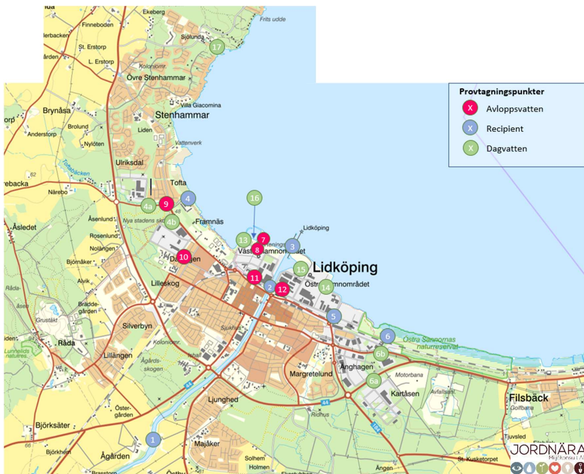
Figur 4. Provtagningsplan med provpunkter för kartläggning av mikroplaster i vatten i Lidköpings tätort. Röda punkter markerar provtagning i spillvatten, blå punkter markerar provtagning i recipientvatten dit dagvatten leds och gröna punkter representerar provtagning i dagvatten (Kartunderlag: ©Lantmäteriet, 2020).
