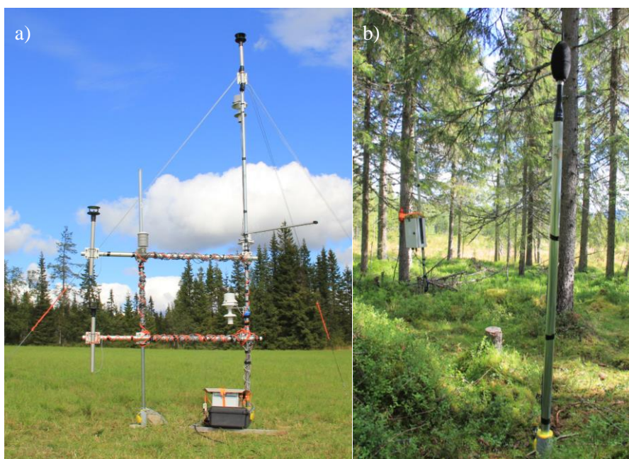
Figur 4.2. a) Meteorologisk mast och b) ljudstation i Malå.
