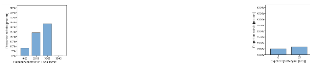
Figur 7.2. Proportion störda deltagare i relation till beräknad bullerexponering. Till vänster beskrivs relationen mellan den momentana bullerexponeringen och antalet deltagare som upplever sig störda. Y axeln beskriver i båda graferna proportionen störda i procent. Till vänster beskriver X-axeln LA eq för 15 minuter i fyra aggregerade kategorier. Till höger beskrivs exponering enligt kommersiella exponeringsmodeller.
