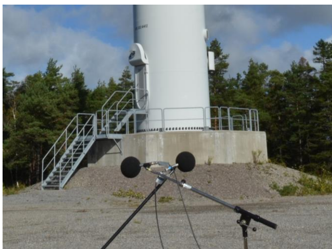
Figur 1 Uppställning vid inspelning av ljud nära ett vindkraftverk på Brattön
