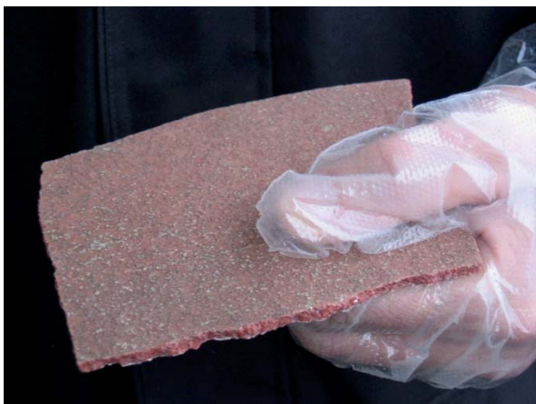
En bit borttagen golvbeläggning med PCB
