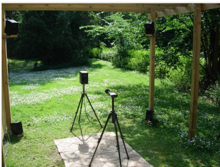
Figur 24. Foto av pergola med åtta högtalare för reproduktion av flygbuller och en högtalare för reproduktion av talsignaler.
