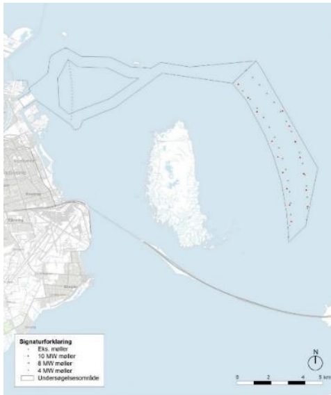
Figur 5-3 Kabelkorridorer for Nordre Flint havmøllepark /7/.
