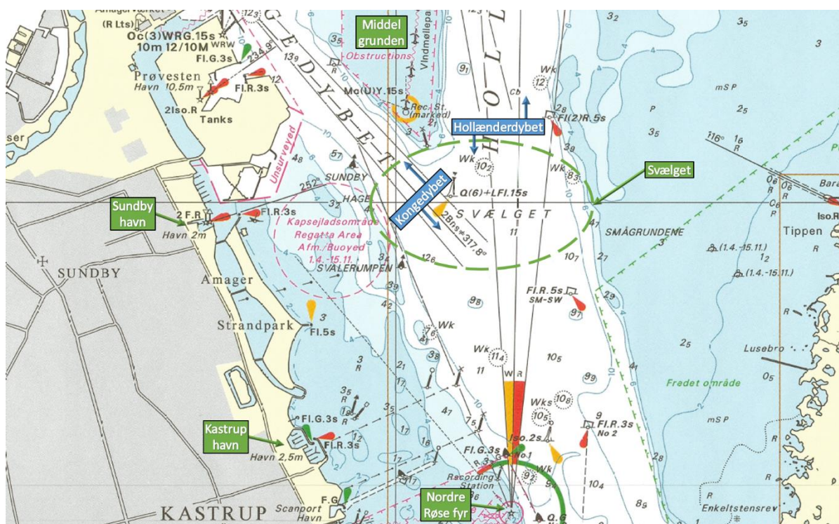
Figur 12-1 Udsnit af søkort med søafmærkninger for Svælget syd for Middelgrunden hvoraf dybdekurver fremgår med forskellige farver, sejlrenden for Hollænderdybet og Kongedybet er angivet og de nærliggende havne og Nordre Røse fyret, Kilde: Søkort "133 INT 1333 Sundet, midterste del". ©Geodatastyrelsen – 320-0147.
