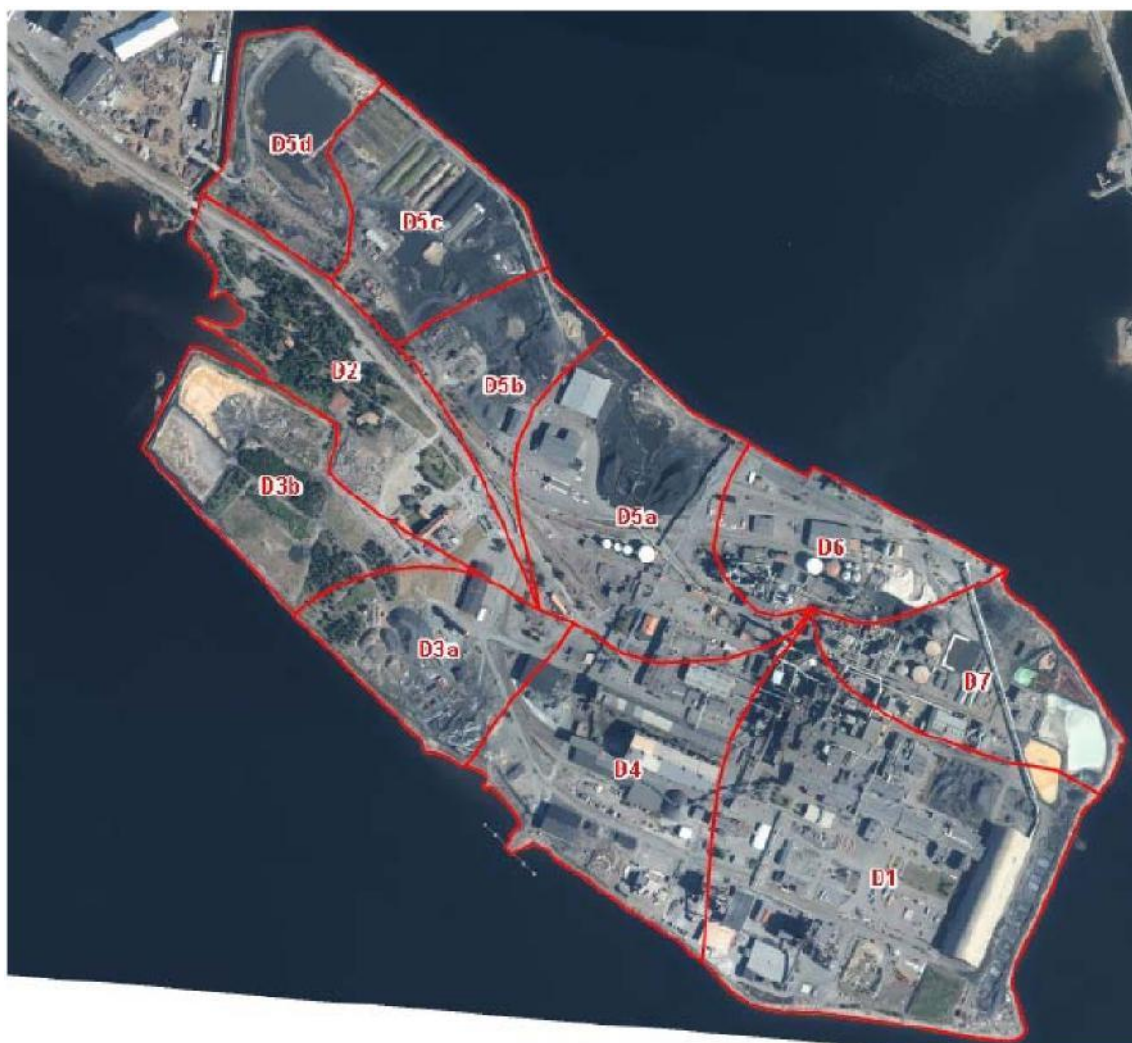
Bild 3. Bilden visar delområden för grundvatten som använts vid riskbedömningen. Indelningen utgår från bedömda avrinningsförhållanden
