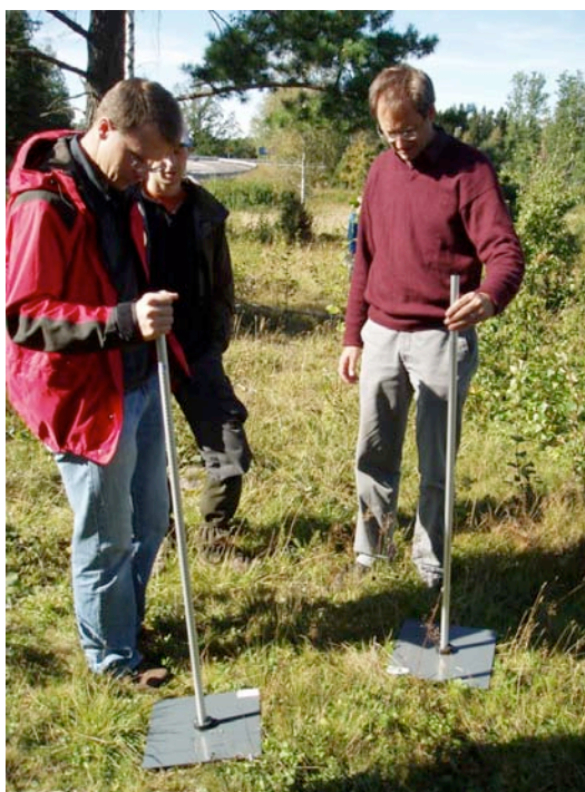
Figur 9. Mätning av vegetationshöjd med gräsmätare.
