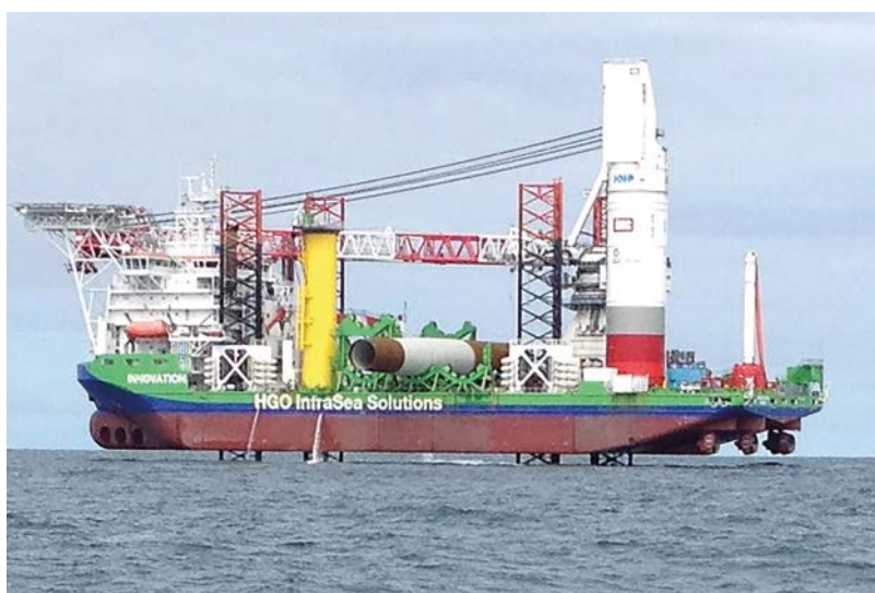
Figur 7 Vänster, pålning av en hamnstruktur i en hamn i Ålseund, Norge (Foto: Mathias Andersson, FOI). Höger, ett pålningsfartyg i den tyska Nordsjön som förberedde en pålning av ett havsbaserat vindkraftsfundament (Foto: Markus Linné, FOI).
