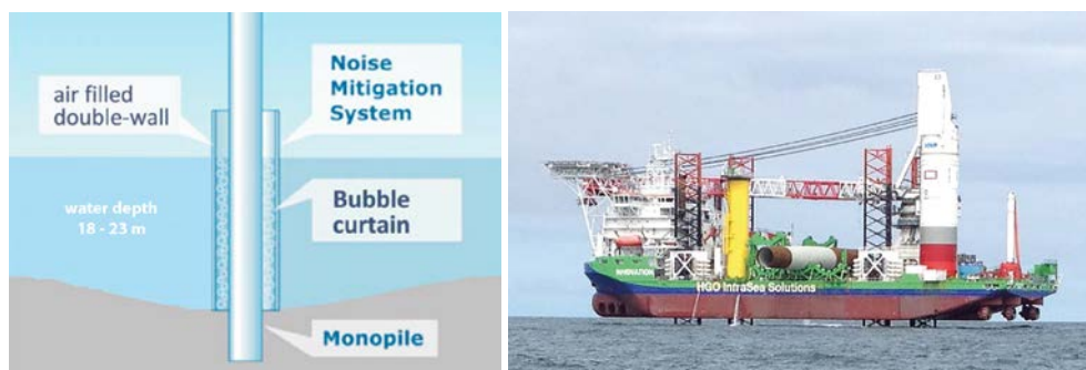
Figur 31 Vänster: En illustration på IHC-NMS system med den luftfyllda dubbelväggen som omsluter pålen och en intern bubbelridå, från Koschinski and Ludemann (2013). Höger: IHC-NMS systemet på plats (röd-vita röret) under en pålning för en vindkraftpark i Tyska Nordsjön (Foto: Markus Linné, FOI).
