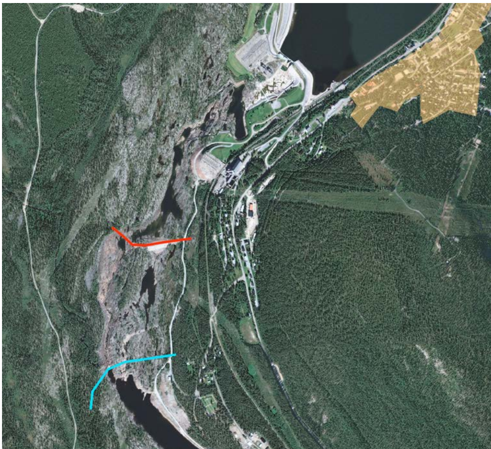
Figur 9. Genomarbetade förslag för förbättrade och mer sammanhållna renskötsellandskap i Sirges sameby. En bred och vegetationsbetäckt renodukt möjliggör för renar att korsa Stora Luleälvens torrfåra nedanför Porjusdammen i anslutning till Porjus samhälle (brandgul yta). Två olika alternativ för placering av en renodukt har utretts och redovisas. Ett förslag på renodukt korsar torrfåran i anslutning till "betongvägen" (röd linje) längs den rutt som idag i nödfall används. En alternativ renodukt skulle kunna placeras vid torrfårans smalaste del vid ovanändan av Harsprångsmagasinet (blå linje). Konstruktionen av en renodukt kombineras med, enligt samebyns detaljkunskap, strategiskt placerade styrstängsel.
