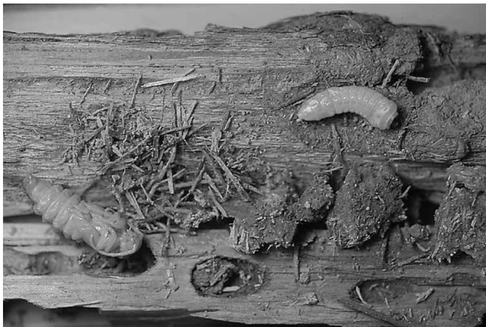
Figur 6. En kläckningsfärdig puppa och en ej fullvuxen larv av raggbock. Notera de grova spånorna (15–25 mm) som bildats i anslutning till förpuppningen. Veden får även karakteristisk rosa färg där larver gnager sig fram, Foto L.-O. Wikars
