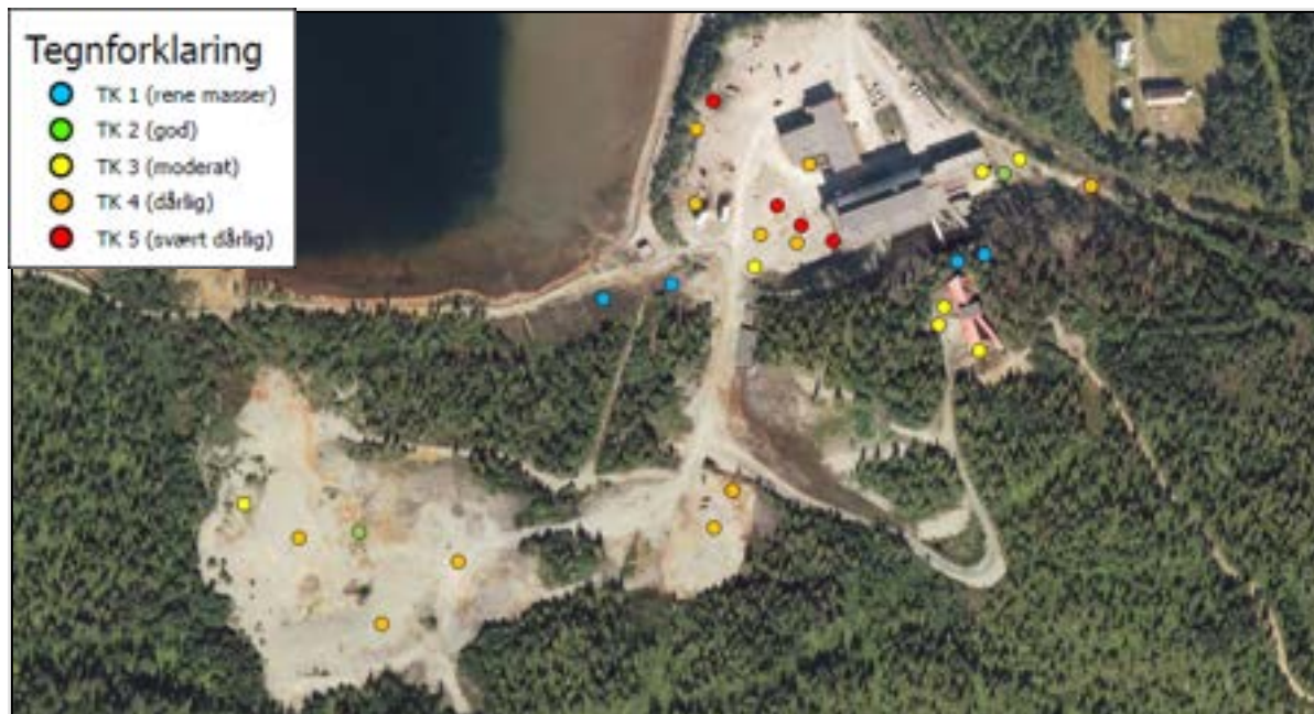
Figur 7-5 Tilstandsklasser av sink i overflatejord. Hvert punkt representerer et gjennomsnitt av fem målinger innenfor en sirkel på 5 – 10 meter (Dato for prøvetaking: 22.09.2020).
