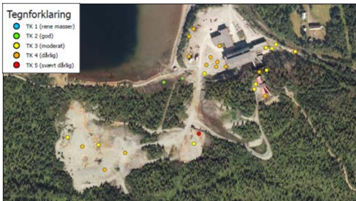
Figur 7-4 Tilstandsklasser av kobber i overflatejord. Hvert punkt representerer et gjennomsnitt av fem målinger innenfor en sirkel på 5 – 10 meter (Dato for prøvetaking: 22.09.2020).
