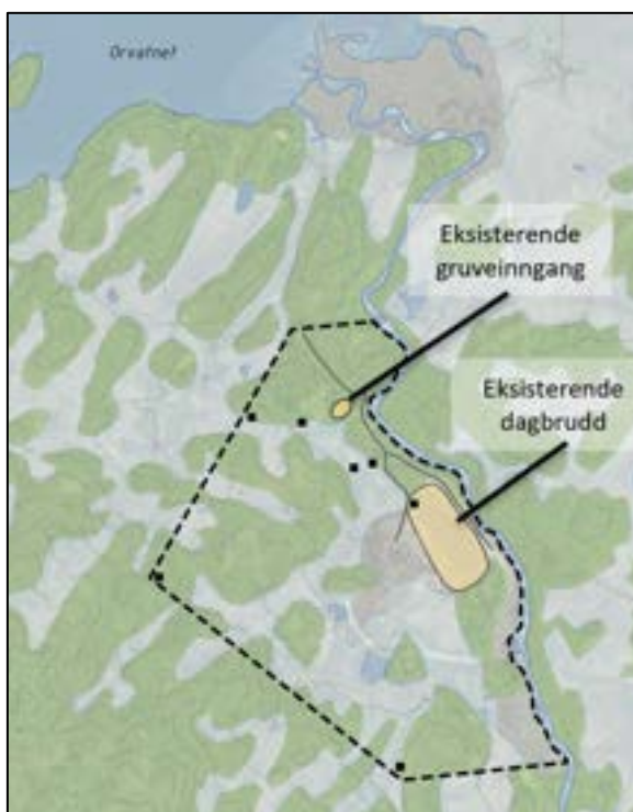
Figur 5-9 Planområdet sør for Orvatnet er markert med svart stiplet linje. Figuren viser eksisterende dagbrudd (oransje område). Luftesjakter vist som svarte firkanter.
