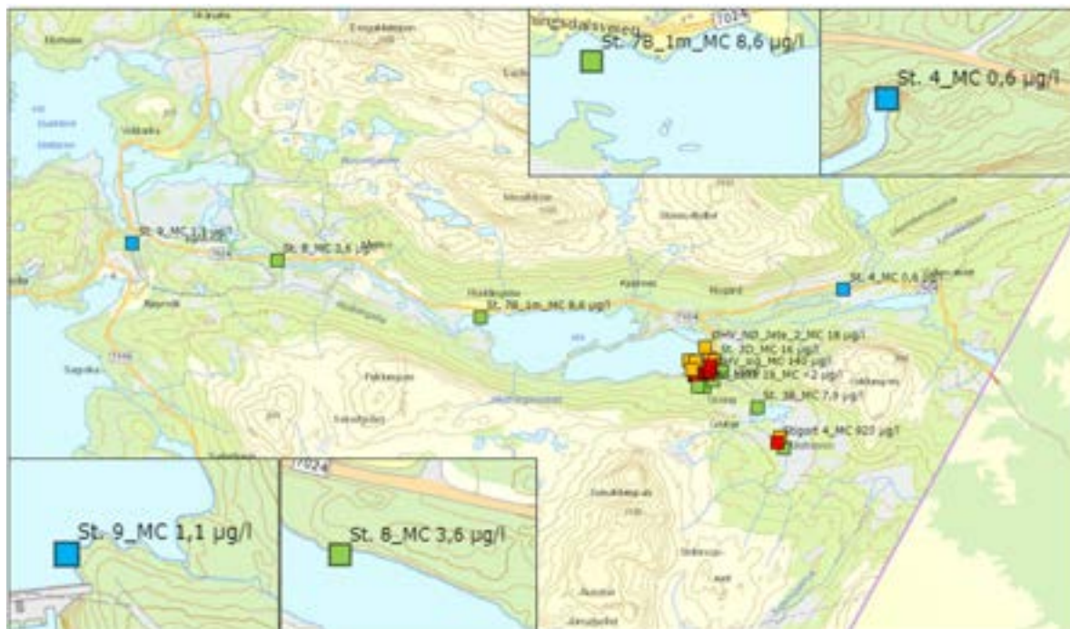
Figur 7-7 Analyseresultater med tilhørende tilstandsklasser for sink i vannprøver hentet i september 2020. Fargekodene er forklart i Tabell 7-6.
