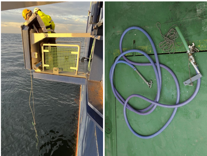
Figur 4. Slang som täcker djupintervallet 0–10 m användes vid de flesta stationerna. Undantagen är: 0–20 m vid stationerna B1 (Askö) och BY31 Landsortsdjupet i Egentliga Östersjön samt 0–5 m vid Råneå-1 i Bottenviken.
