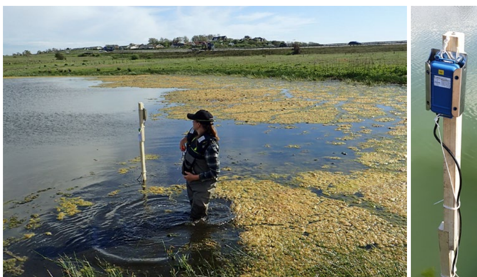
Figur 4. Foto på en av de 122 vattennivåmätarna i en våtmark, infällt, närbild på en nivåmätare. Foto: Lea D. Schneider.
