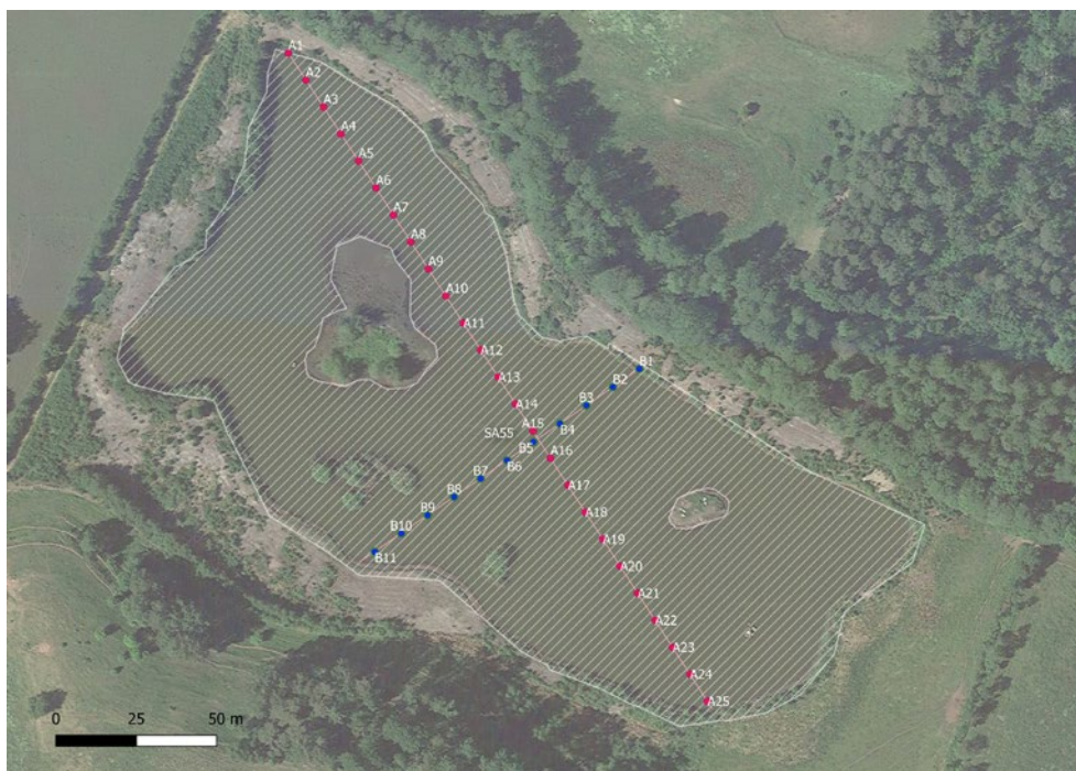
Figur 13. Exempel på utplacering av transekter och provtagningspunkter i QGIS vid inventering av undervattensväxter.
