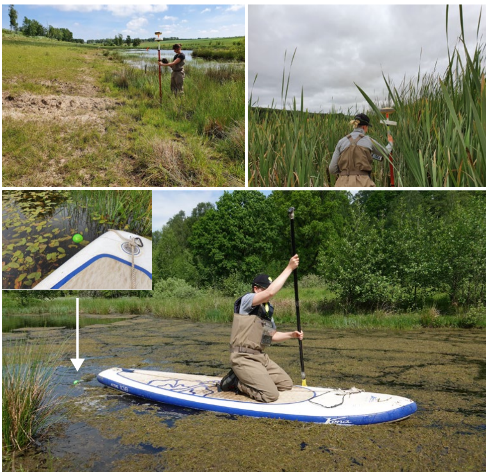
Figur 5. Överst: inmätning med GPS av våtmarkernas strandlinje vid aktuell vattennivå (vänster, Foto: Sofia Hedman) samt i grundare och vegetationsrika partier (höger, Foto: Lea D. Schneider). Nederst: ekolodinmätning med Deeper (den gröna bollen på bild) med hjälp av SUP på öppet vatten. Foto: John Strand.
