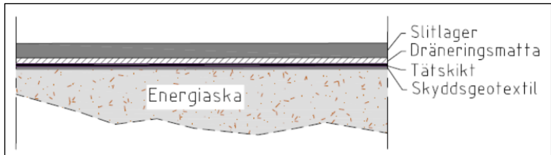
Figur 4, Sektion över behandlingsyta uppbyggd av energiaska.
