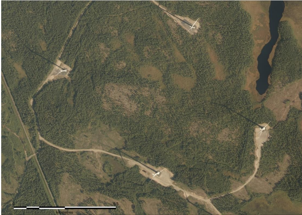
Bild 10. Flygbilden visar vindkraftverk i drift. Servicevägar och lyftfält har byggts för vindkraftverk. I närheten av vindkraftverken och i mellanområdena har den tidigare markanvändningen varit oförändrad.
