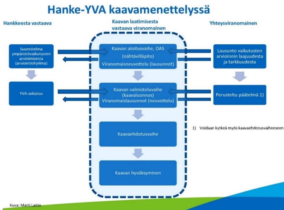
Kuva 11. MKB-förfarandet i förhållande till planläggningsprocessen enligt markanvändnings- och bygglagen (Bild: Miljöministeriet, Matti Laitio).
