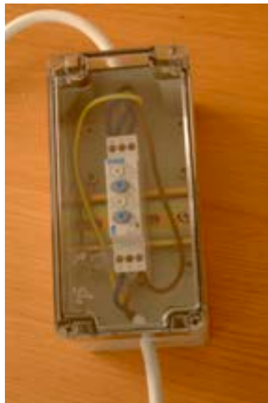
Figur 3. Tidur som styr den intermittenta provtagningen.
