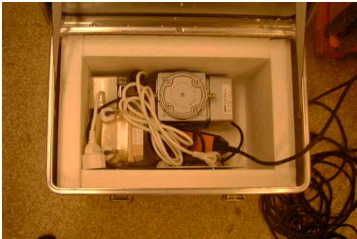
Figur 1. Uppvärmad isolerad låda med tidur, pump och gasmätare.
